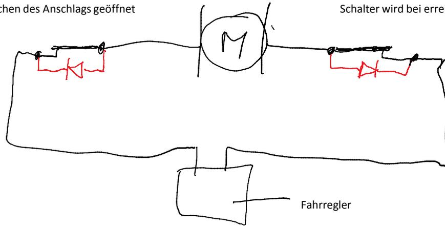
Sollte der Motor bei Erreichen des Anschlags zwar den Schalter öffnen, er aber nicht stehen bleiben, muss die Diode, die den Schalter überbrückt, umgedreht werden.
